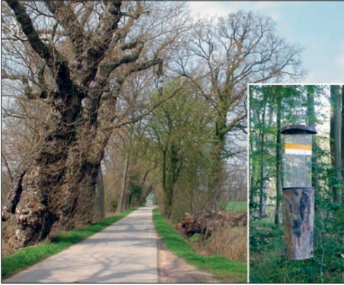
Abbildung 6: Luftelektor in der Bliestorfer Schwarz-Pappel-Allee. Eingeklinktes Bild: Detailansicht der Luftelektoren nach Rahn (Fa. bioform). Die Bauhöhe der Falle beträgt rd. 1 m, die Höhe der Prallscheiben 50 cm. Diese Fallen werden zum Betrieb an einer Schnur in den Kronenraum gezogen
